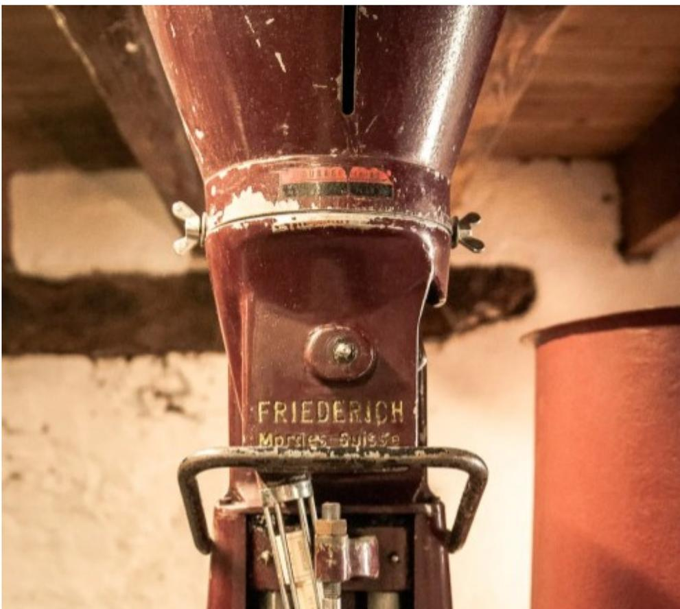
Machine pour mettre les bouchons
